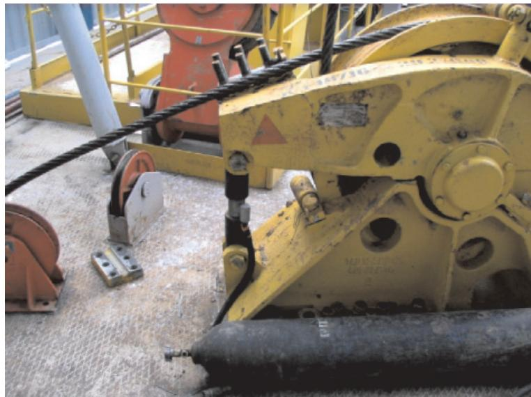
Рис. 35. Пример установки датчика растяжения конструкций крепления (ICS SW-00) (ООО «Геотек-Прибор»), диапазон измерения силы натяжения, кН (тс) – 0-227 (22,7); пределы допускаемой основной приведенной погрешности (от верхнего диапазона измерений), % –  $\pm 0,2$ )
