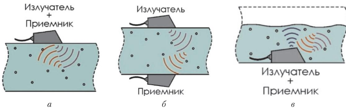
Рис. 64. Принципиальная схема работы доплеровских датчиков расхода для напорных закрытых каналов с совмещенными излучателем и приемником (а), с разнесенными излучателем и приемником (б) и для открытых ненапорных каналов с совмещенными излучателем и приемником (в)
