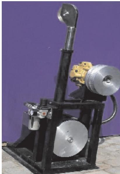
Рис. 103. Датчик положения крюка со встроенным датчиком вертикальных перемещений (качки) (Heavesensor&HookePositionSensor) (производство LidaLTD)
