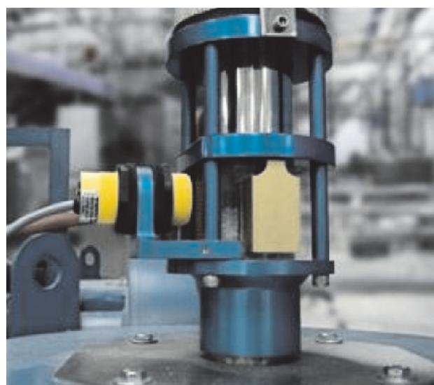
Рис. 4. Общий вид емкостного преобразователя для измерения давления
