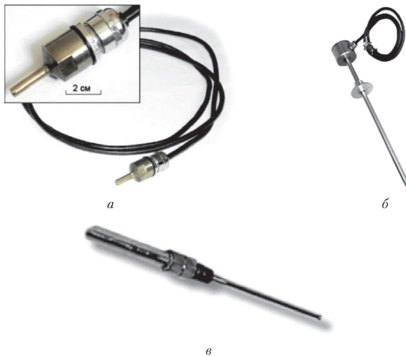
Рис. 86. Датчики температуры:
