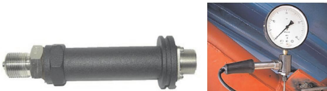
Рис. 60. Общий вид тензометрического датчика давления буровой жидкости
