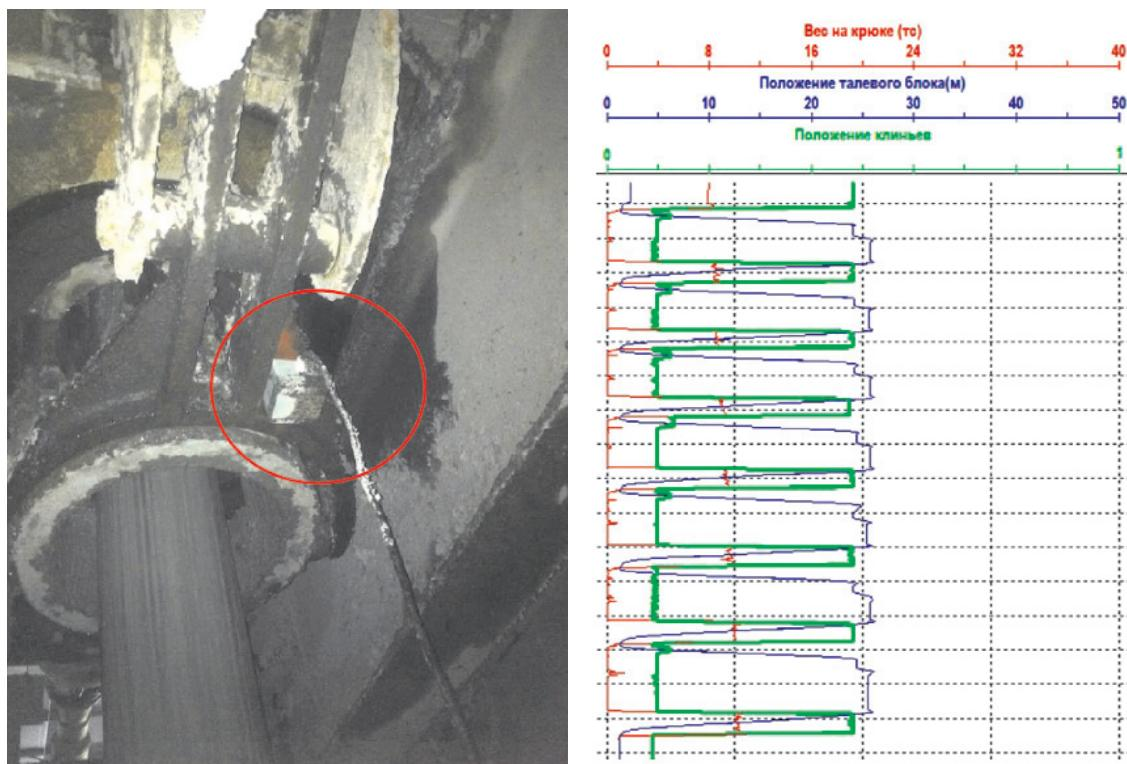
Рис. 42. Пример акселерометрического датчика положения клиньев на подвижной тяге привода клиньев (производства ЗАО АМТ, на основе триаксиального акселерометрического сенсора)
