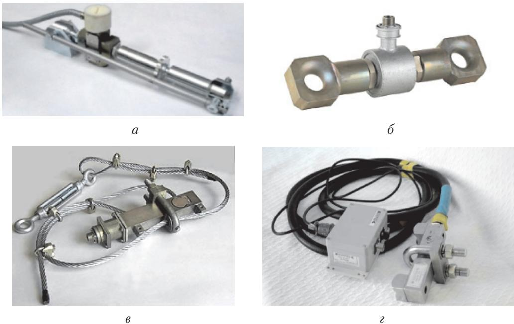
Рис. 13. Датчики измерения реактивного момента (растяжения), устанавливаемые в разрывы: ДМР-315-05.1 (ЗАО «ГЭЛС») (а), ДКМР-2 (СКБ «Ореол») (б) и накладываемые на неподвижную ветвь троса: ДКМ (ОАО НПФ «Геофизика») (в), ICS SK (ООО «Геотек-Прибор») (г)
