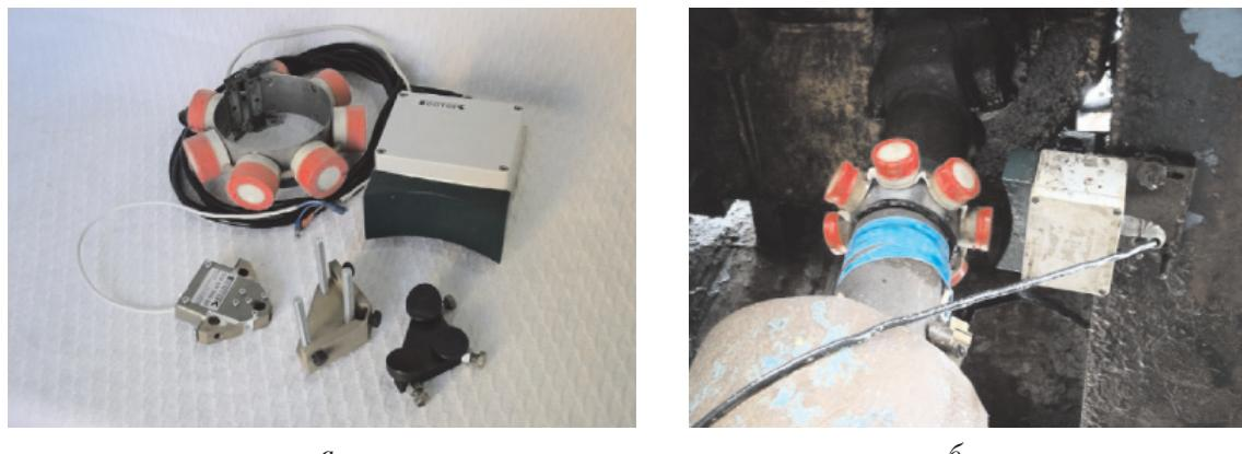
Рис. 9. Измеритель момента скручивания вала привод aICS SM 006 (ООО «Геотек-Прибор»):
